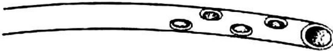
Figure 1. Drain tubulaire multiperforé.
